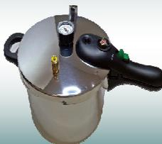
OLLA NEUMÁTICA para polimerización de resinas y otros componentes del sector dental. Acero inox y con capacidad de 6 litros y presión de trabajo 2 bar. Cuenta con 2 válvulas de seguridad que actúan cuando supera la presión máxima. Entrada para conexión de aire a presión con llave de apertura y cierre.
